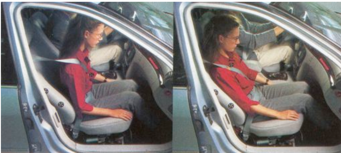
Abb. 13 Per PreSafe gestraffter Gurt, in: DaimlerChrysler (Hg.), HighTech Report 2001, S. 28
